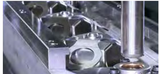
Ergebnisse im Werkzeugunterteil - nach erfolgtem Biegevorgang
