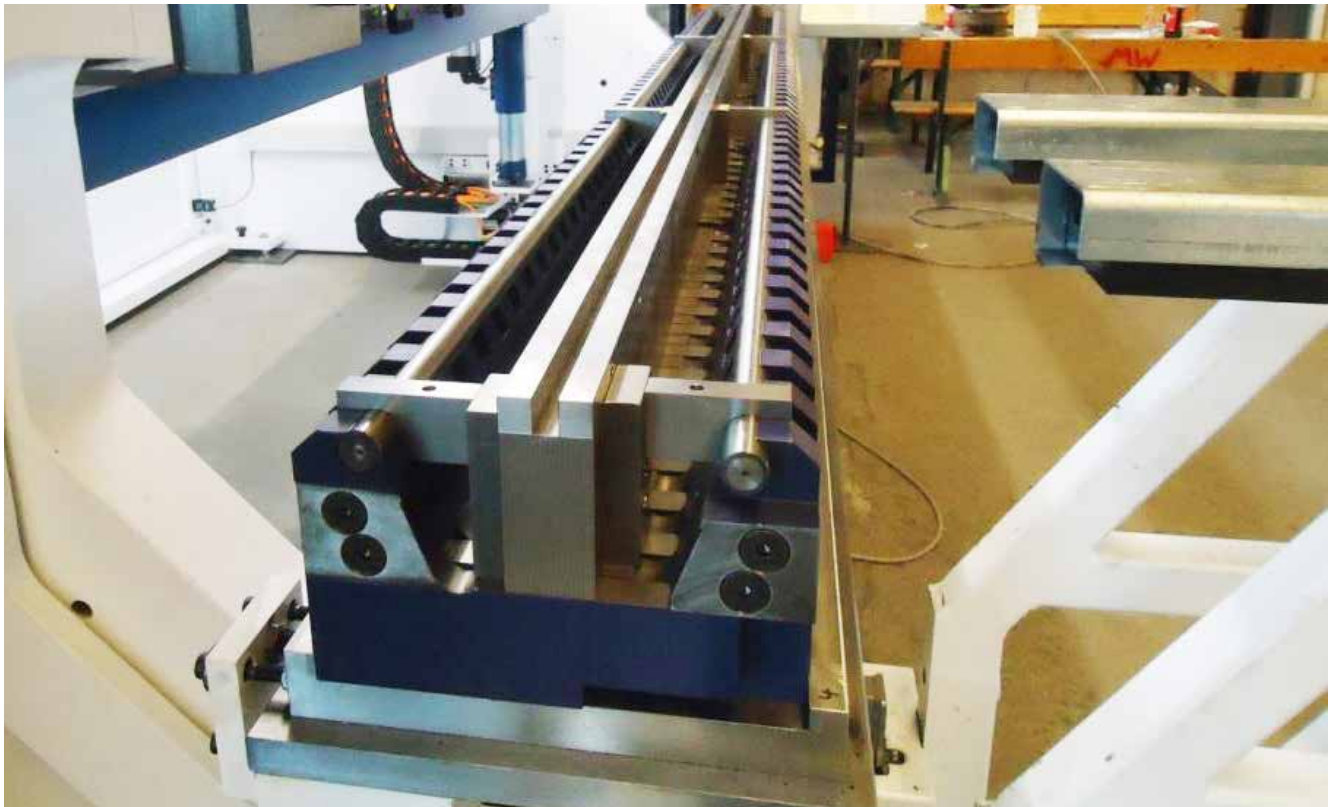
verstellbare Matrize mit eingesetzter Adapterschiene
