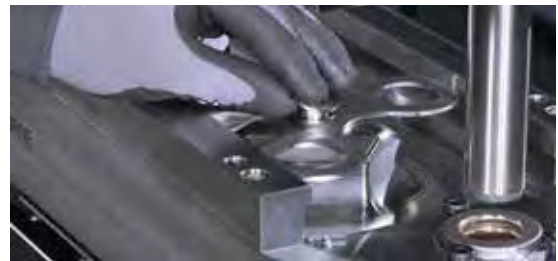
2. und 3. Fertigungsschritt: Einlegen der Platinen und der Oberteil-Innenringe in alle 3 Stationen
