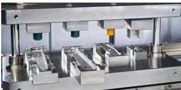
säulengeführtes Sonderwerkzeug mit vier Arbeitsstationen zur Herstellung von verschiedenen Prägungen
