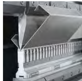
bei Lochblechen Wiederholgenauigkeit mit konstanten Schenkelhöhen und exakten Winkeln
