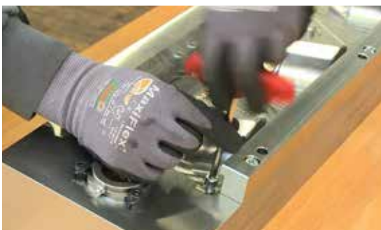
Endmontage des Werkzeugunterteils
