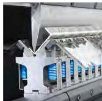
bei Tränenblechen und Riffelblechen abdruckarm an der Sichtseite
