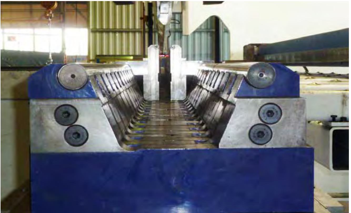
verstellbare Matrize mit Biegeeinsatz für kleinere V-Öffnungen
