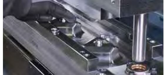
1. Fertigungsschritt: Einlegen der Unterteil-Innenringe in alle 3 Stationen
