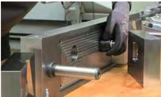
Endmontage des Werkzeugoberteils
