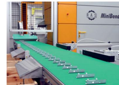
Fertigteile auf Förderband getaktet
