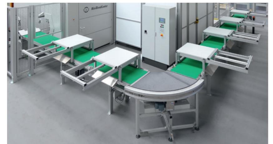
Fertigteilauslauf mit Kurvenband zum Ausschleusen von Biegeteilen in sechs Boxen
