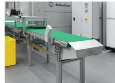
Linearer Fertigteil-Auslauf mit einer Ausschleusstation
