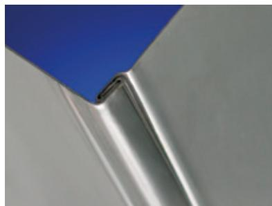
Mit speziellen Rollen lässt sich der DuctZipper RAS 20.10 für Edelstahlkanäle bis 0,8 mm Blechdicke einsetzen
