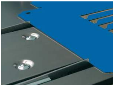
Abhängig vom Maß positionieren die vorderen oder hinteren pop-up Finger das Blech
