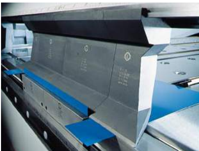
Geteilte Biegewangenwerkzeuge z. B. für versetzte Biegelinien
