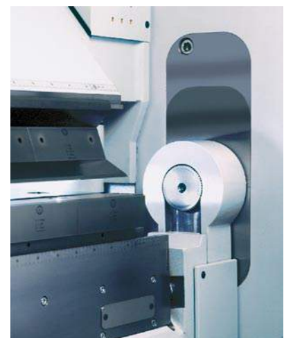
Die automatische Drehpunktverstellung sichert erstklassige Biegeteile.
