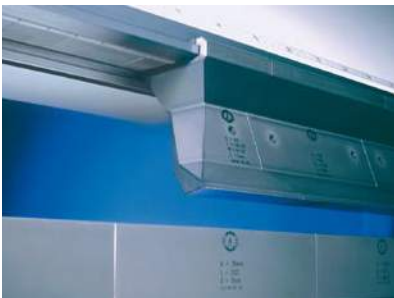
Das Klemmsystem spannt die Oberwangen-Werkzeuge automatisch.
