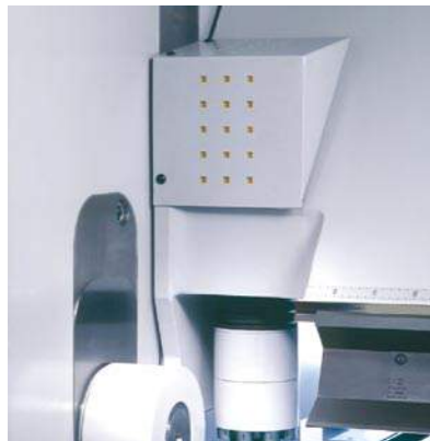
PowerBooster erzeugen 120 Tonnen Spannkraft. Ergebnis: Perfekte Umschläge und enge Biegeradien.
