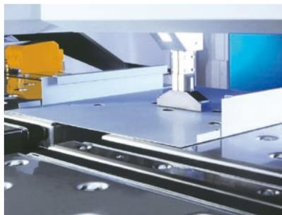
Der Hauptmanipulator positioniert und dreht das Biegeteil 1/1000 Grad genau.
