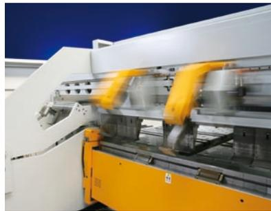
Kurze Werkzeug-Wechselzeiten durch unabhängige Greiferarme
