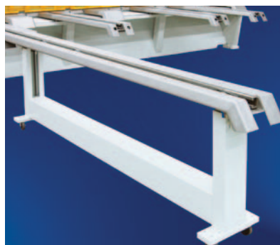
Die verfahrbare Tischverlängerung ist in Sekundenschnelle angekoppelt und verlängert die Blechunterstützung am Winkelanschlag oder der Tischverlängerung.
