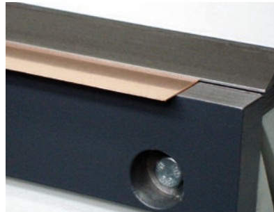
Einstellung der Biegewange bei dünnen und dicken Blechen
